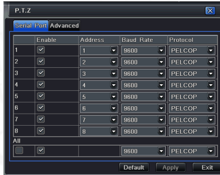
4-36. ábra P.T.Z beállítás –soros port
